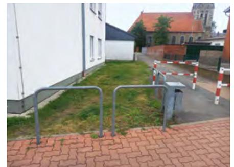
**Fahrradbügel zur Absperrung:** Sie sollen hier verhindern, dass die Drängelgitter umfahren werden.
